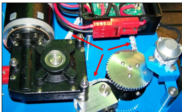
Abbildung 6 - Schmierung der Antriebskette
